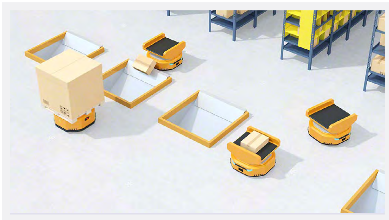
Rys. 3.47. Roboty mobilne sortujące paczki firmy Mecalux
