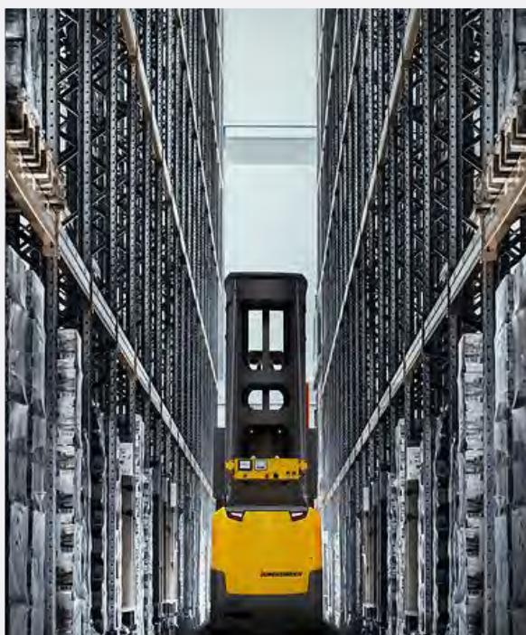
Rys. 3.20. Automatyczne wózki systemowe Jungheinrich – wózki przeznaczone do pracy w bardzo wąskich korytarzach regałów
