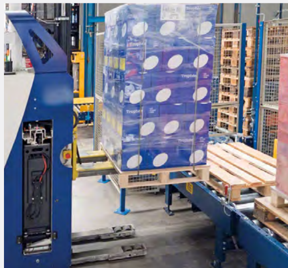
Rys. 3.21. Wózki AGV poruszają się po magazynie bez nadzoru
