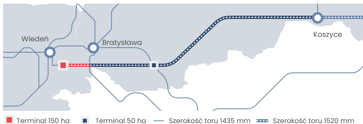
Rys. 4.3 Szeroki tor linii łączącej Koszyce z Bratysławą i Wiedniem – styk między siecią kolejową o rozstawie 1435 mm i 1520 mm [109]
