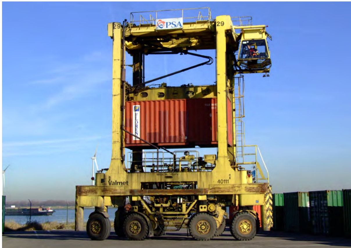
Rys. 2.4 Wóz kontenerowy podsiębierny [50]
