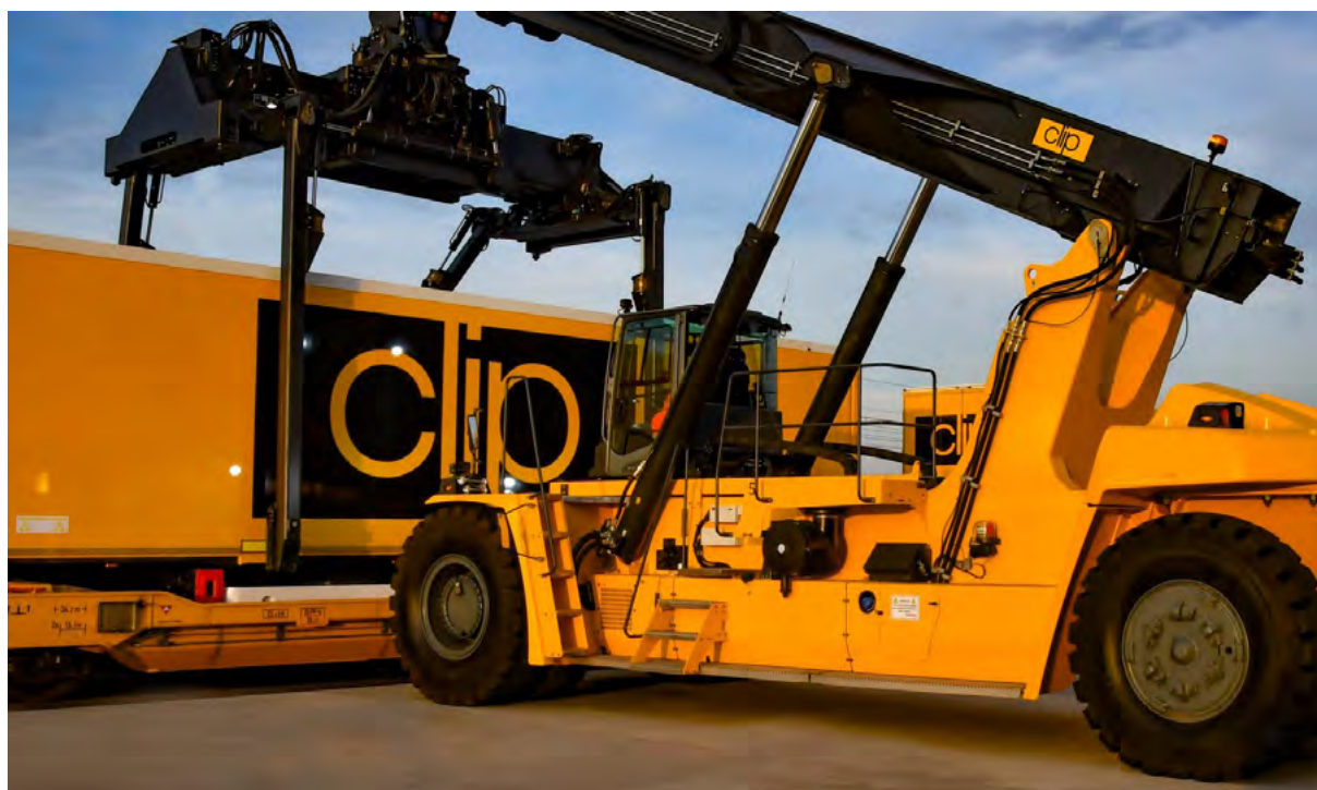
Rys. 2.3 Przeładunek naczepy za pomocą kleszczy reachstackera [49]
