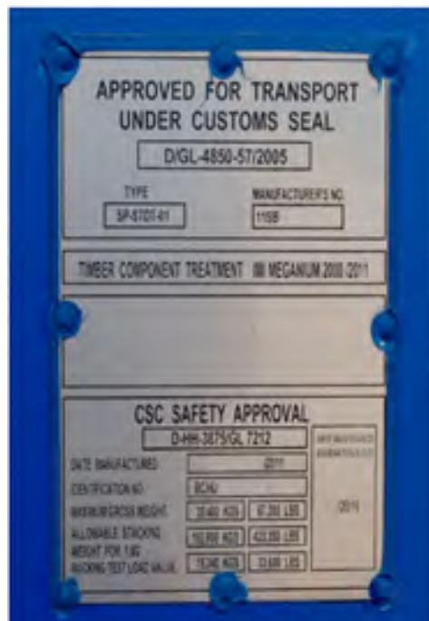
Rys. 2.19 Przykładowa tabliczka CSC [60]
